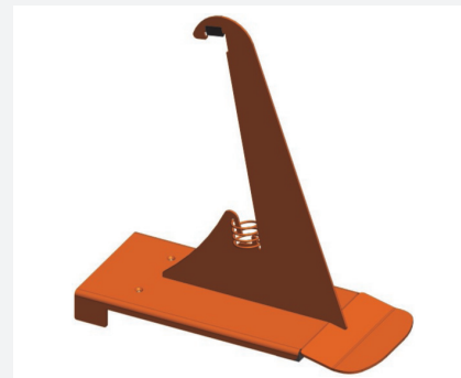
Schneefangstütze Nr. 85 PV 250 mm hoch, 100 mm Stuhlhöhe Art.-Nr. 030460 verzinkt Art.-Nr. 030465 beschichtet
