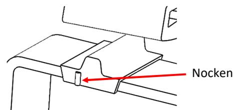
Dichtelement mit den seitlichen Nocken zum First hin auf die Einhängung des Solarhalter schieben / aufstecken. Der Nocken dient als Positionierungshilfe.
