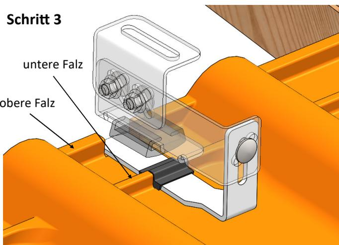
Das Dichtelement formschlüssig zur annähernden Schließung der Aussparung an die Verfaltung des Ziegels ausrichten. Je nach geometrischer Form des Ziegels (Falz- Wasserverlauf), können die Falze einfach oder doppelt geschlossen werden.
