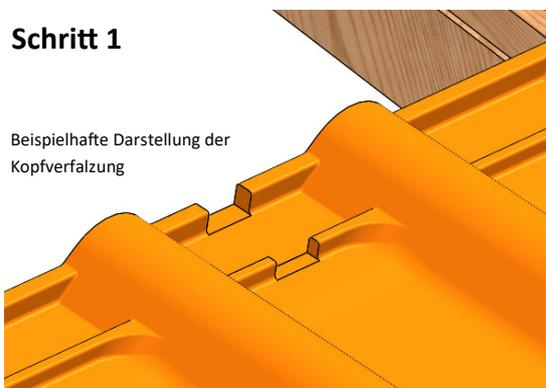
Kopfverfaltung des Dachziegels mittels Dachziegelfräse, oder vergleichbares, bearbeiten. Optimale Breite der Aussparung: ca. 35 mm.
