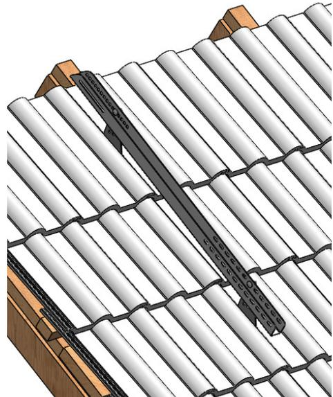
Tragprofil seitlich (links) an Stützen montieren.
